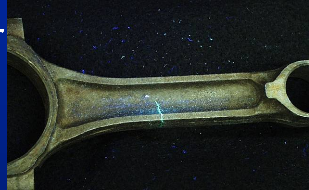
Indicație cu penetrant fluorescent
